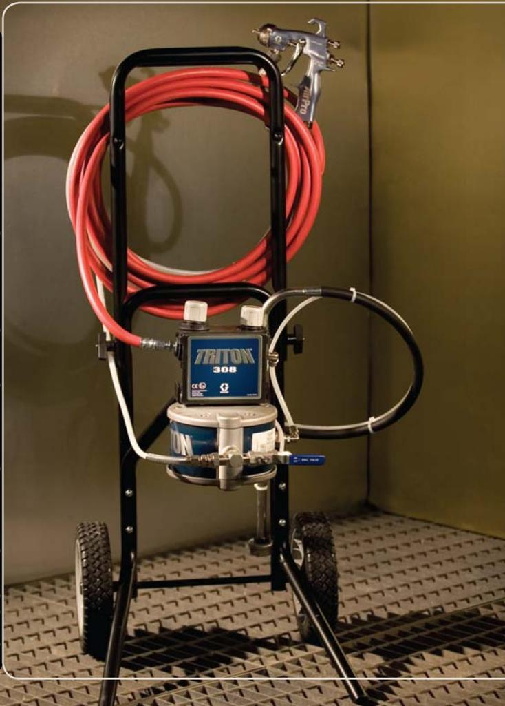
**TRITON** est un groupe de pulvérisation pneumatique à double membrane capable d'appliquer une finition décorative de haute qualité sur des pièces en bois et en métal. TRITON constitue une alternative plus efficace aux pots sous pression traditionnels et aux pompes à membranes standard.
